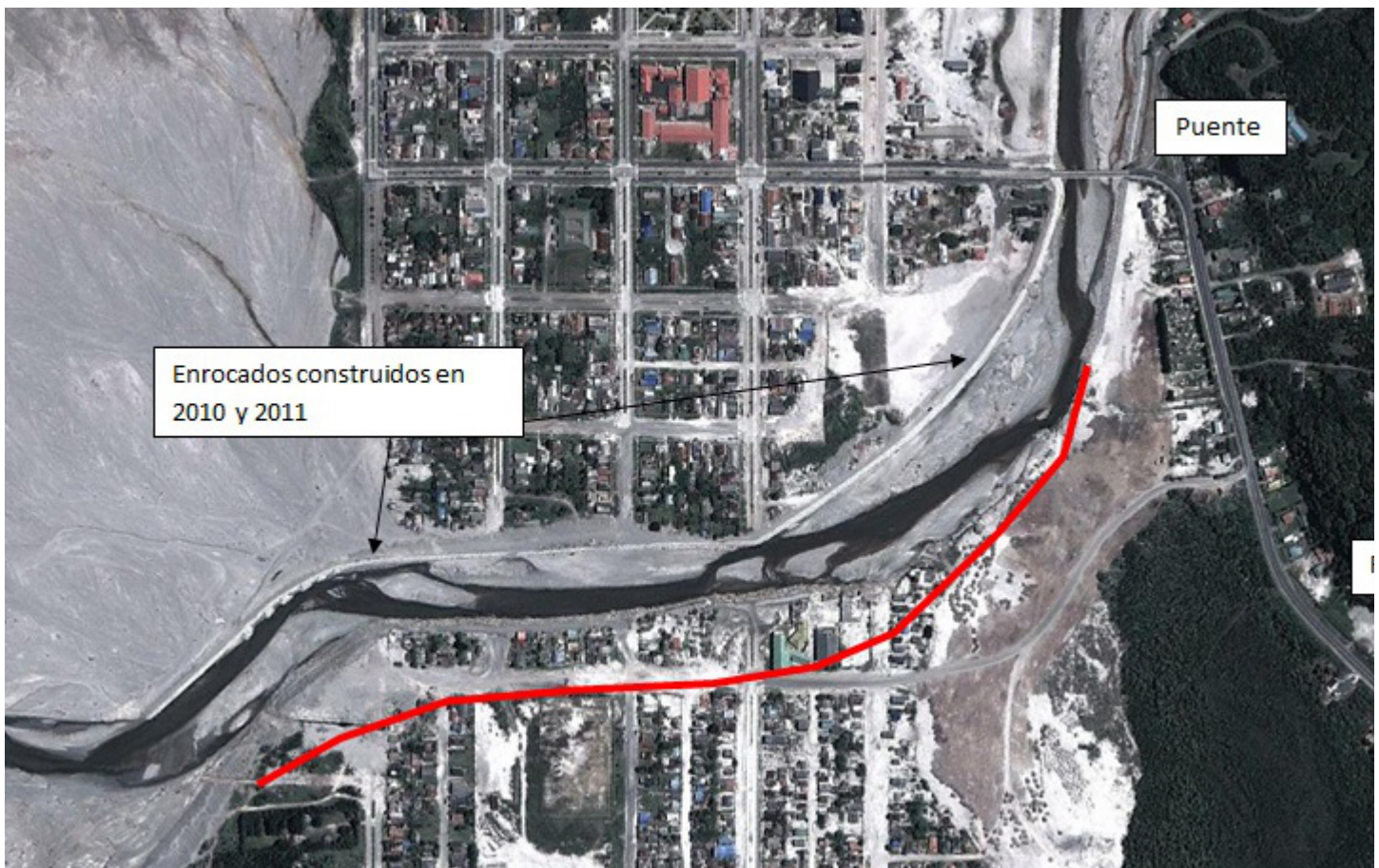
Figura 11. Muestra planta del Pueblo de Chaitén sobre una imagen de Google Earth de enero de 2013 y en rojo el trazado para el enrocado del lado sur para el año 2013 en la que se aprecian los enrocados construidos en la ribera norte el año 2010-2011.
