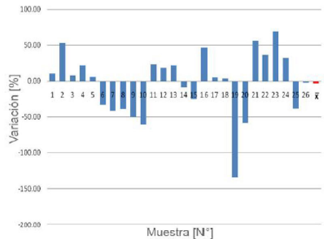
Figura 4.1 – (a) Grafico de renovaciones de aire naturales a 4Pa. (b) Grafico de % de variación en Infiltración.
