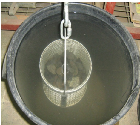
Fig. 5.- Determinación de densidades (Fuente: Serrano 2010)
