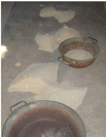
Fig. 4.- Método de cuarteo a la arena de relave (Fuente: Serrano 2010)
