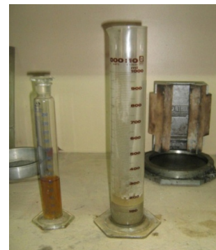
Fig. 6. Determinación colorimétrica (Fuente: Serrano 2010)
