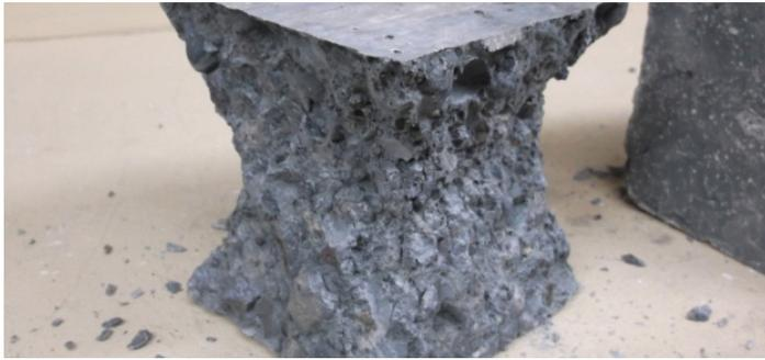
Figura 4. Probeta ensayada a compresión
