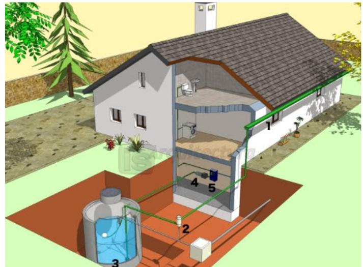
Figura 19. 1.- Captación, 2.- Filtro, 3.- Depósito, 4.- Bomba, 5.- Conmutado y/o control
