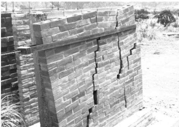
Figura 21: Falla ante carga lateral de muro de mampostería estructural con ladrillo industrial
