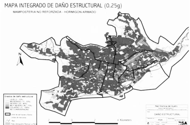
Figura 1.- En rojo el daño esperado en estructuras de concreto y mampostería en sismo con aceleración estimada de 0,25 g, magnitud considerada como posible en la zona. Fuente: Red sísmica del austro, Universidad de Cuenca
