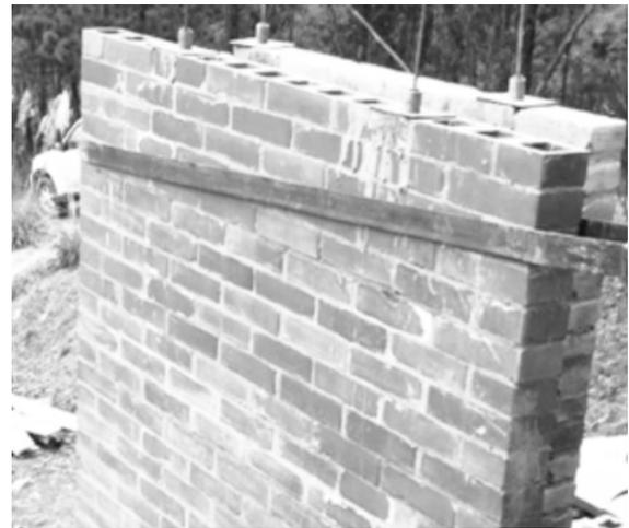
Figura 22: Falla ante carga lateral de muro de mampostería post-tensada con ladrillo industrial.
