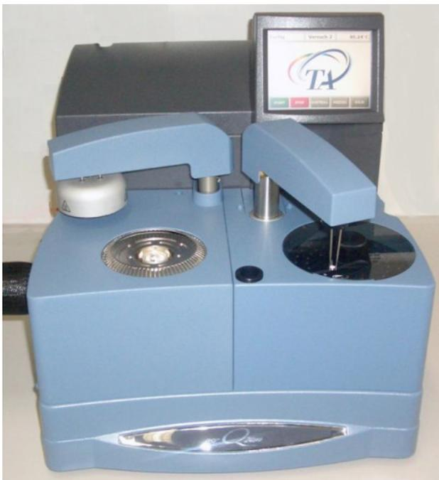
Figura 10. Equipo para Barrido Calorimétrico por Escaneo Diferencial
