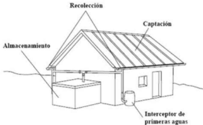
Figura 8. Sistema básico de captación de aguas lluvias
