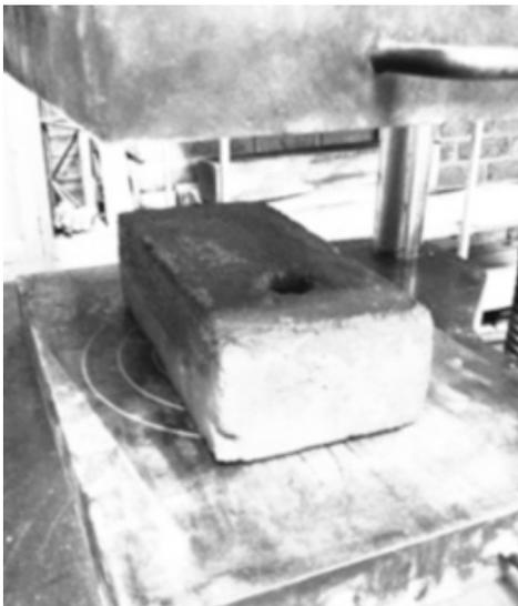
Figura 17 : Ladrillo artesanal “panelón” perforados en ensayo a compresión.
