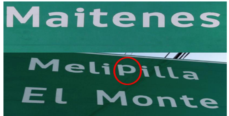
Figura 6. Falla en alineación vertical; Fuente: Tesis Diseño UC, Victoria Gallardo, Tipografía y Legibilidad en Señales de Tránsito.
