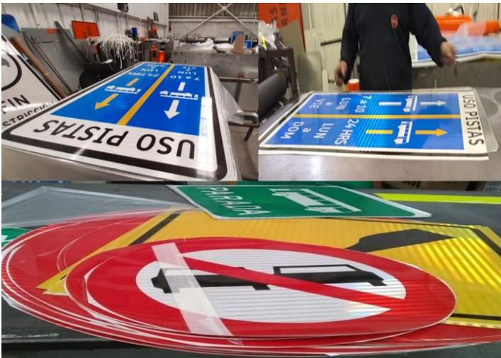
Figura 14. Corte y pegado sobre el sustrato metálico.
