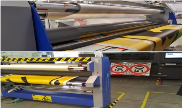
Figura 13. Colocación de lámina de protección U.V.
