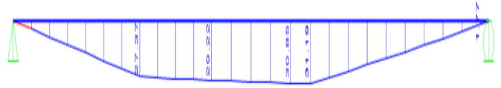
Figura 8. Diagrama de momento flector, con un valor máximo de 30,85 ton·m.
