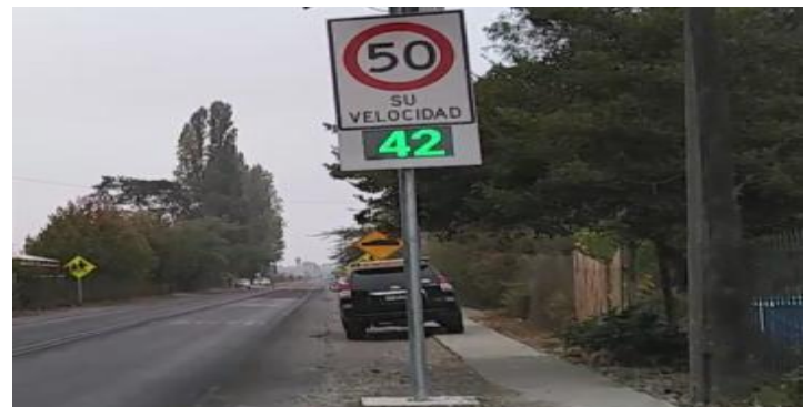
Figura 2. Radar de velocidad con indicación en color verde para velocidad inferior al límite permitido.
