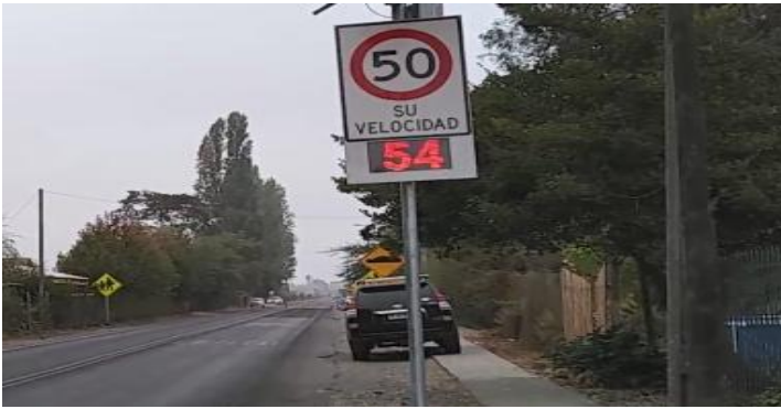
Figura 3. Radar de velocidad con indicación en color rojo por exceder la velocidad máxima permitida.
