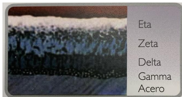
Figura 1. Capas de aleaciones zinc-hierro. (Fuente: GYMSA).
