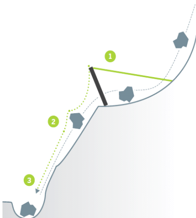
Figura 1. Geometría simplificada del atenuador. Esquema que muestra la evolución de un bloque que llega a un atenuador en tres pasos (impacto, guiado y recolección).
