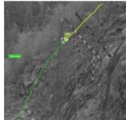
Figura 10. Seguimiento de un bloque a lo largo de su caída con el software Kinovea.
