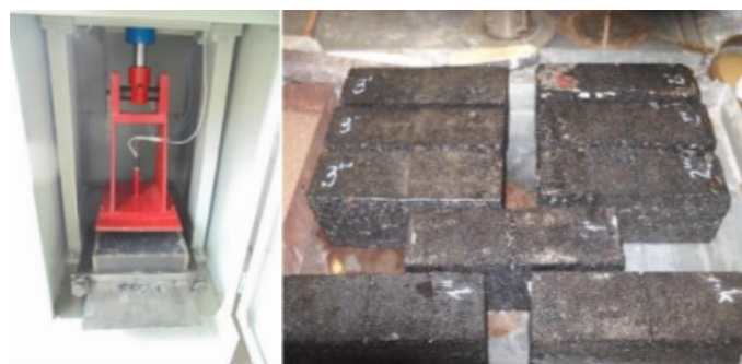
Figura 3. a) Equipo Roller Compact; b) Probetas elaboradas.
